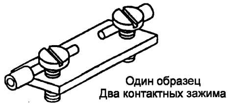
Рисунок F.1 — Непосредственный зажим головкой винта неподготовленных проводников
