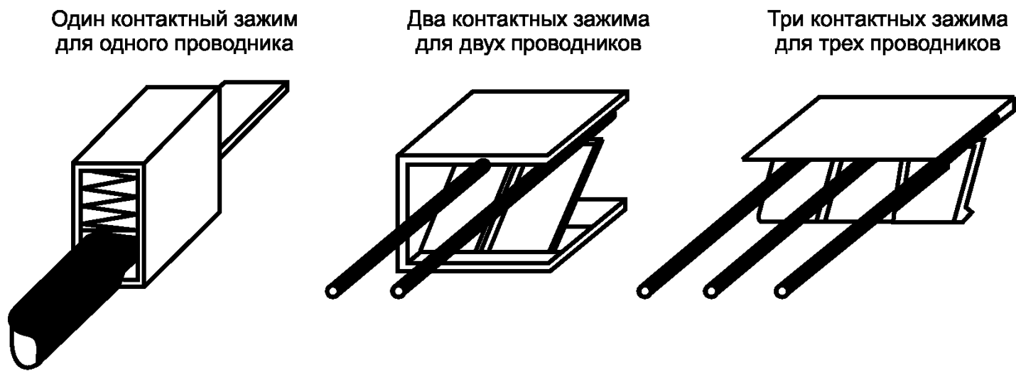
Рисунок F.6 — Примеры безвинтовых контактных зажимов
